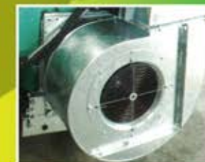
فن Centrifugal unit
